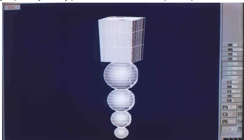
Rys. 1. Geometria zestawu badawczego odlewów kul \phi 100, \phi 80, \phi 60 i \phi 40
