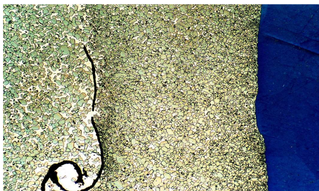
Rys. 6. Warstwa tlenków Al powstała w strukturze kompozytu
