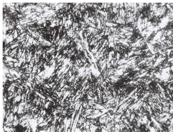
Rys. 3. Struktura stali po hartowaniu z temp. 990°C w oleju i odpuszczaniu w temp. 660°C. Martenzyt wysokoodpuszczony. Traw. Chlorek żelaza Pow. 1000x
