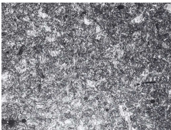
Rys. 2. Struktura stali po hartowaniu z temp. 990°C w oleju i odpuszczaniu w temp. 660°C. Martenzyt wysokoodpuszczony. Traw. Chlorek żelaza Pow. 500x
