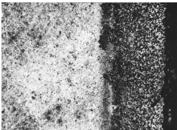
Rys. 4. Struktura stali ulepszonej cieplnie i azotowanej w temp. 500°C, 36h. Od powierzchni: faza \epsilon+\gamma , faza \alpha z wydzieleniami azotków, martenzyt wysokoodpuszczony. Traw. Chlorek żelaza Pow. 200x
