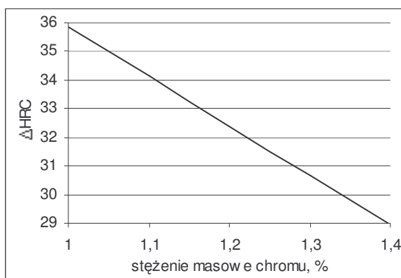
Rysunek 11. Wpływ chromu na różnicę \Delta HRC twardości między punktami o największej i najmniejszej twardości dla stali do nawęglania (tablica 2).
