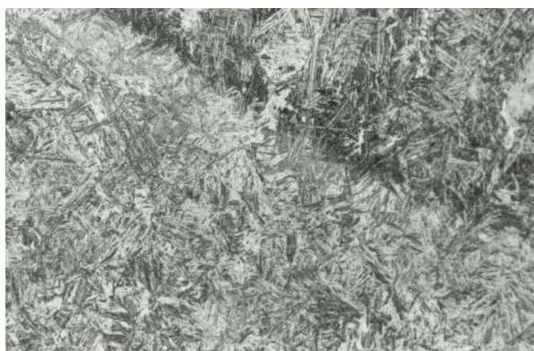
Rys. 6. SWC PN materiału rury sterowej. Pow. 800 X. Trawiono nitalem
