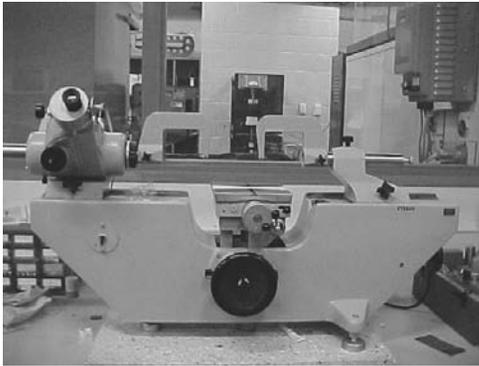
Fig. 1. Metroscope
