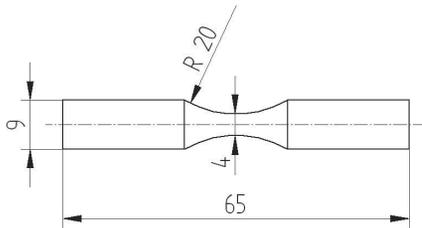
Fig. 1. Rotating-bend fatigue test specimen
