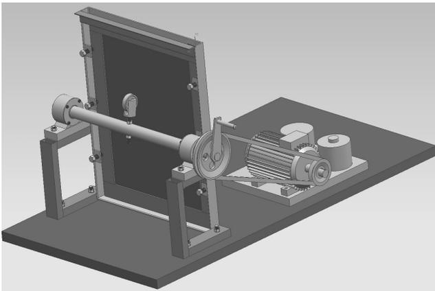
Fig. 4. Fatigue test stand
