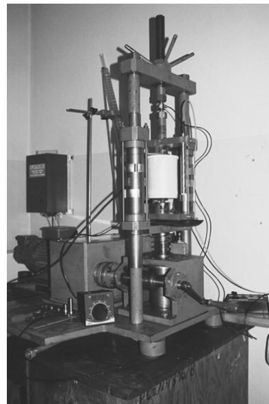
Fig. 8. The SSRT machine
