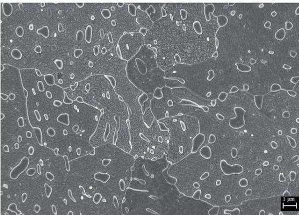
Fig. 3. Parent unhardened material 19312 (5000x)
