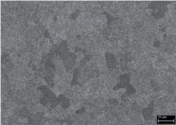
Fig. 2. Parent unhardened material 19312 (1000x)
