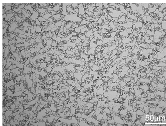
Rys. 3. Mikrostruktura stali 18Mn wygrzewanej w 750°C i chłodzonej z V_{750-500}=78^{\circ}\text{C/s}
