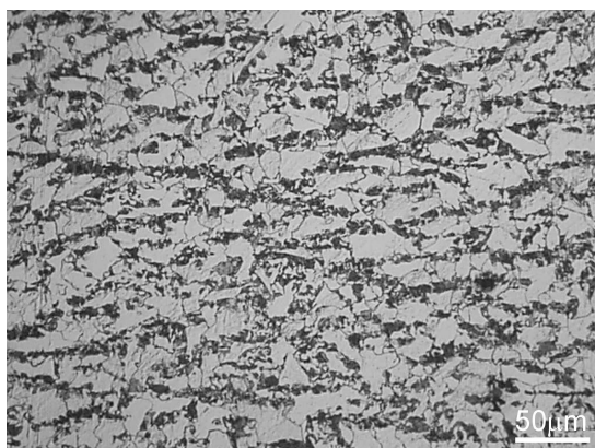
Rys. 2. Mikrostruktura stali 18Mn wygrzewanej w 750°C i chłodzonej z V_{750-500}=4^{\circ}\text{C/s}
