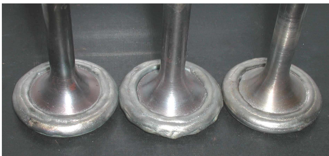
Rys. 3. Widok zaworów próbnych napawanych PTA proszkami na osnowie kobaltu EuTroLoy 16006, EuTroLoy 16012 oraz PG 5218 firmy Castolin, urządzeniem EUTRONIC GAP 200, rys. 8 i tabl. 7
